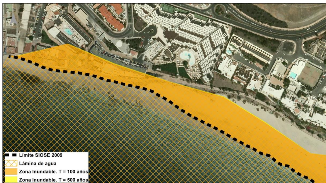
Figura 26. Ejemplo con la zona inundable delimitada por el SIOSE 2009 y la lámina de agua hasta el mismo
