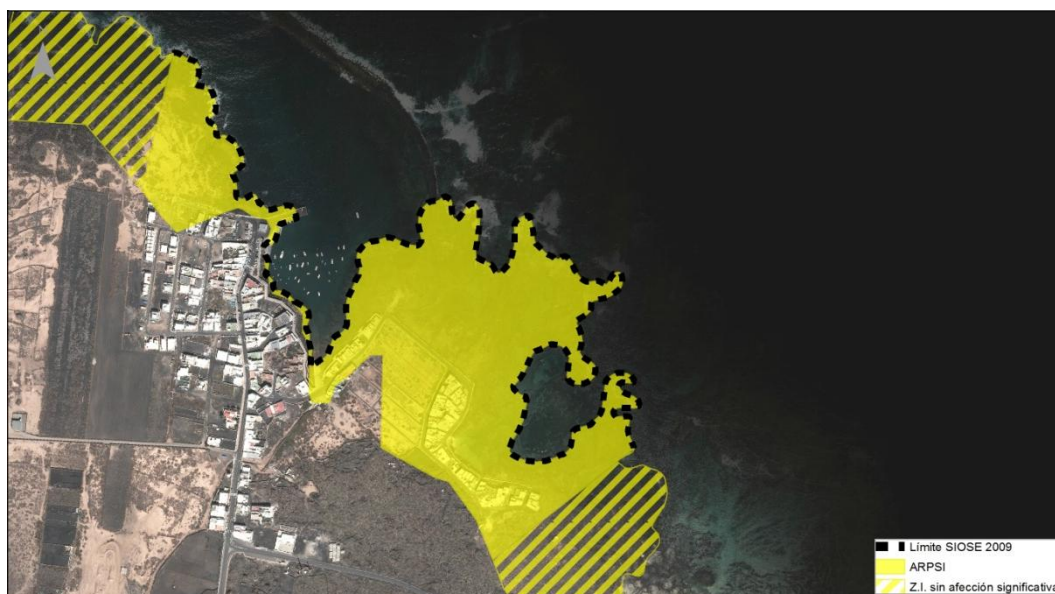
Figura 29. Ejemplo de aplicación del criterio utilizado para delimitar lateralmente las ARPSIs
