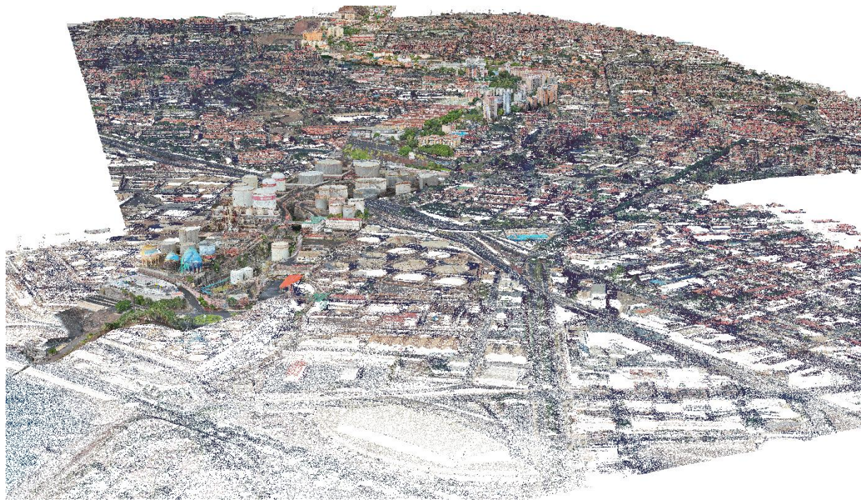
Figura 12. Nube de puntos RGB del Vuelo fotogramétrico del ARPSI ES124_0028 Bco. del Hierro (Santa Cruz de Tenerife) sobre el vuelo LiDAR PNOA de 3ª cobertura
