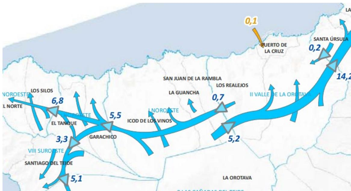
Figura 16. Transporte de agua en el norte de Tenerife. Plan hidrológico de Primer ciclo.
